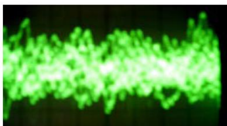
Рис. 2. Осциллограмма о наличии влаги
