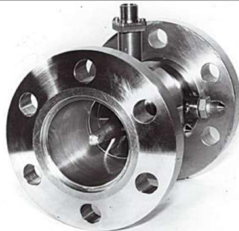
**Рис. 3.** «Преобразователь И.П. Андреева» (SU 1058415) с компенсацией скольжения по перепаду давления в каналах лопастей вращающейся вертушки (вид по потоку и против потока)
