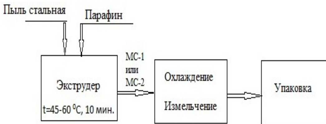
Рисунок 2 – Технологическая схема получения магнитосорбентов
